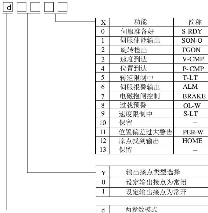
图 4-5-2 可编程输出端子功能设定示意图
