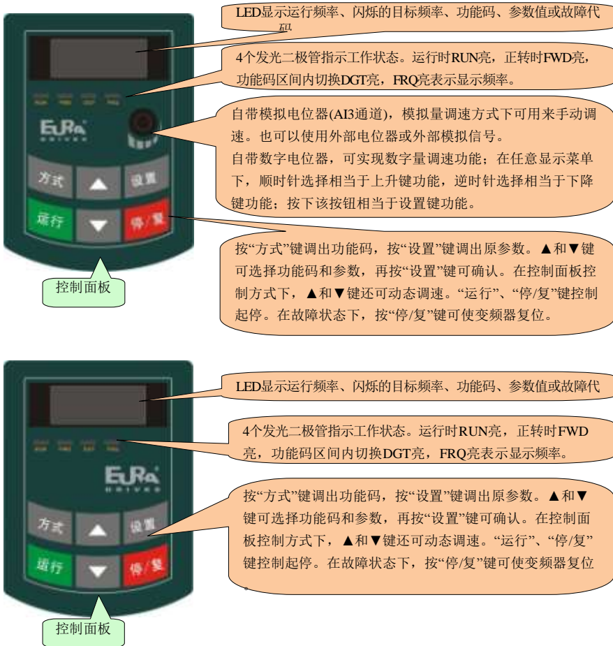
图2-1 控制面板示意图
