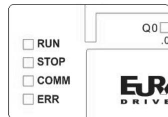
故障 (ERR) 指示灯用于指示 CPU 检测到了程序运行错误、通讯故障、硬件故障等。当在运行中检测到错误时，CPU 会依据错误状态的级别来进行错误处理。如果是致命错误，CPU 会立即停止执行正常的工作循环，同时切换到停止状态，并点亮故障指示灯，提示用户排除故障。
