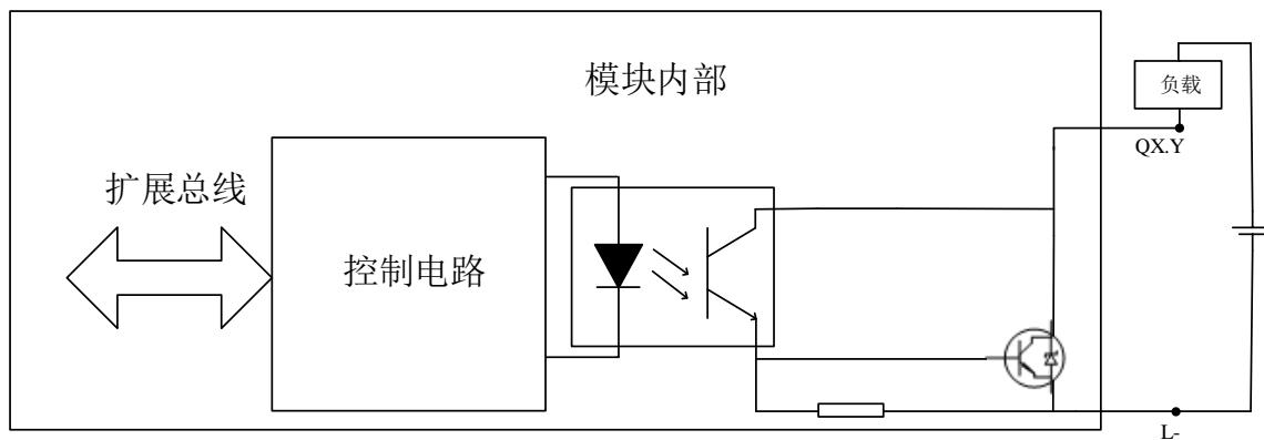
图 4-11 DO 漏型电气原理图
