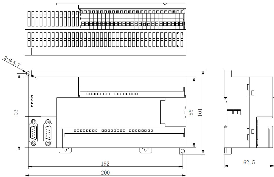
图 2-8 P5 外形尺寸及安装图
