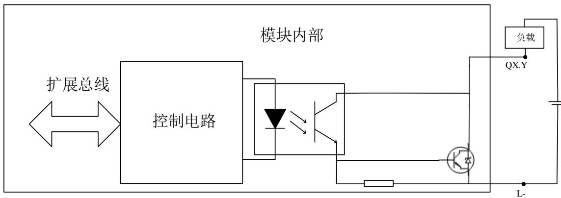
图 4-19 DO 漏型电气原理图
