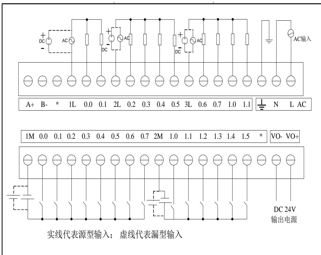
图 3-11 EC204-24AR 接线图
