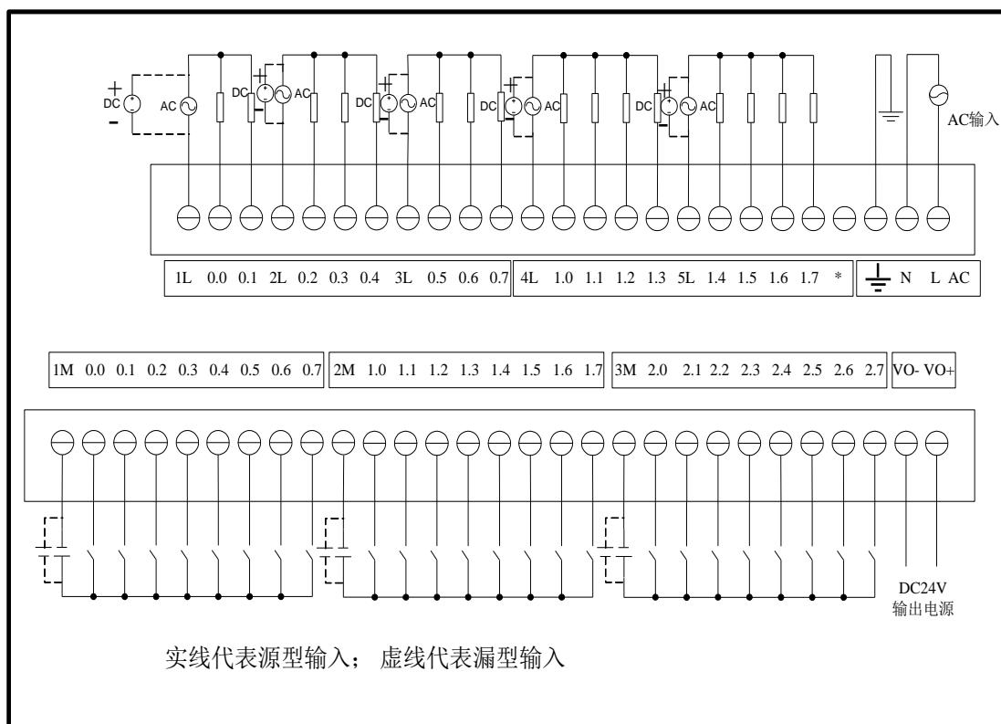
图 3-15 EC206-40AR 接线图
