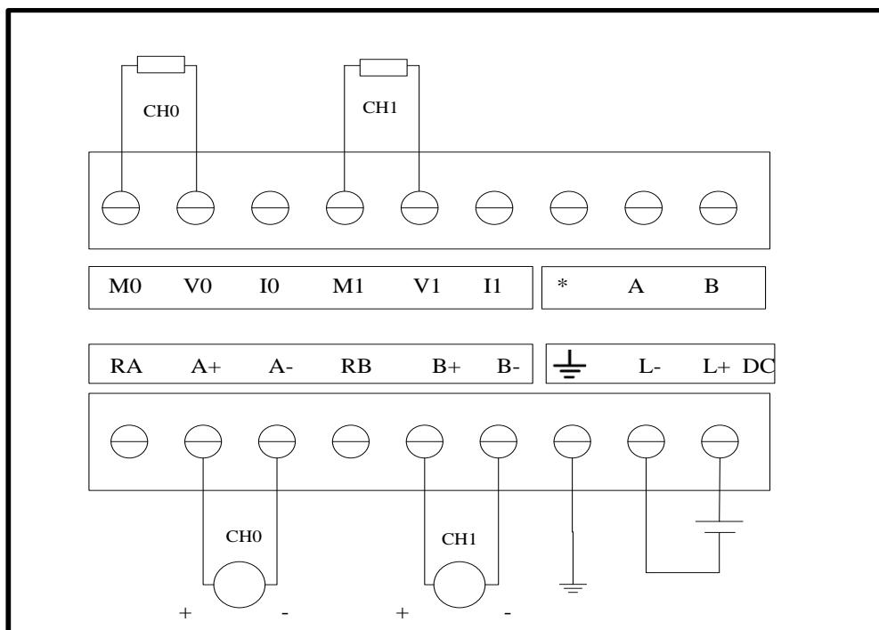
图 5-18 EC233-04IVM 电压模式接线图
