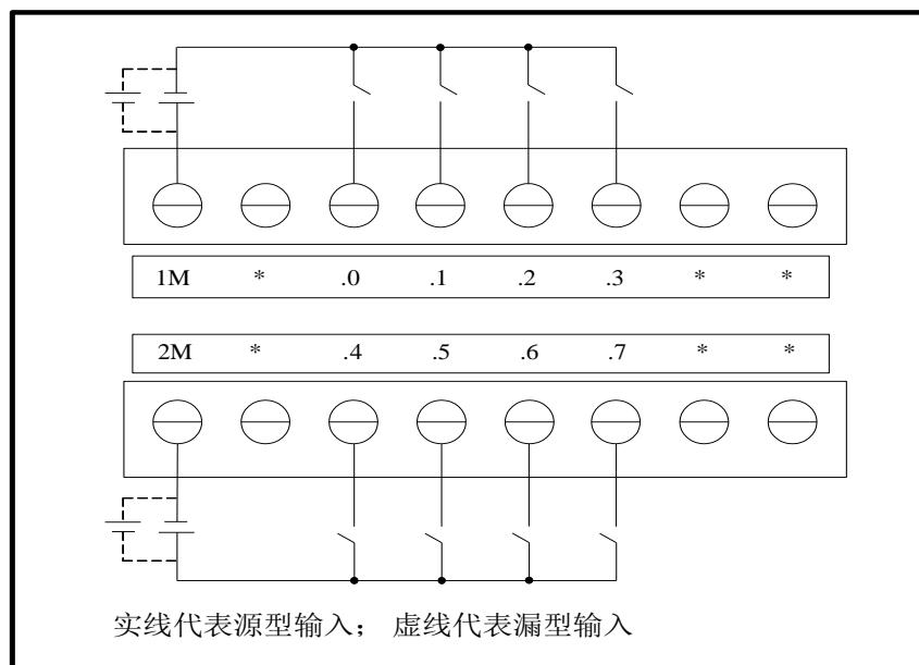
图 4-2 EC221-08DX 接线图
