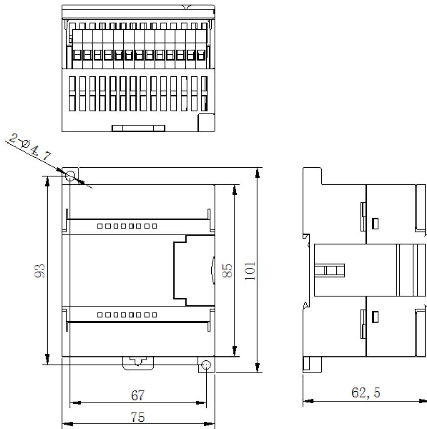
图 2-5 P2 外形尺寸及安装图
