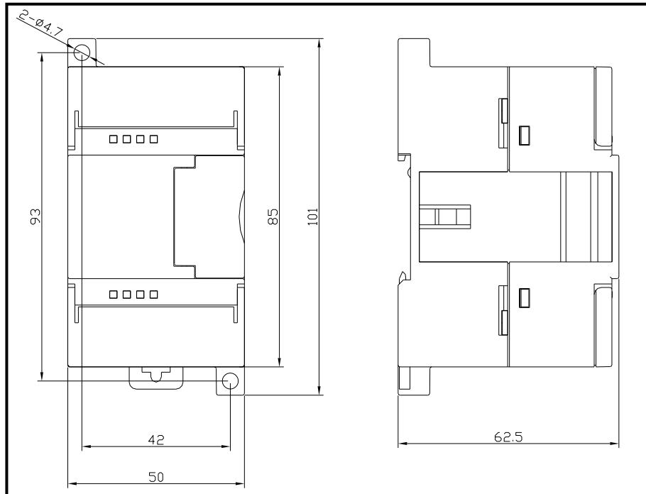
图 5-5 EC231-04IVM 安装尺寸图
