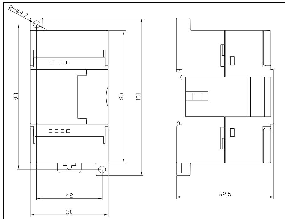
图 5-21 EC233-04IVM 安装原理图
