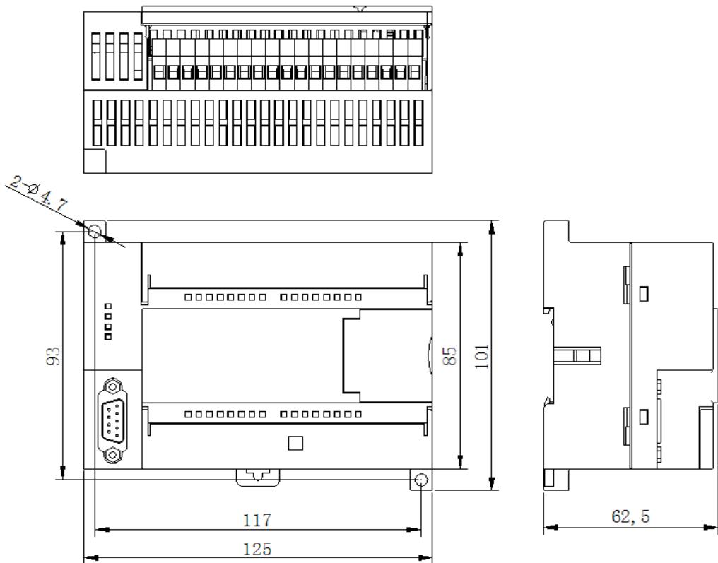
图 2-7 P4 外形尺寸及安装图
