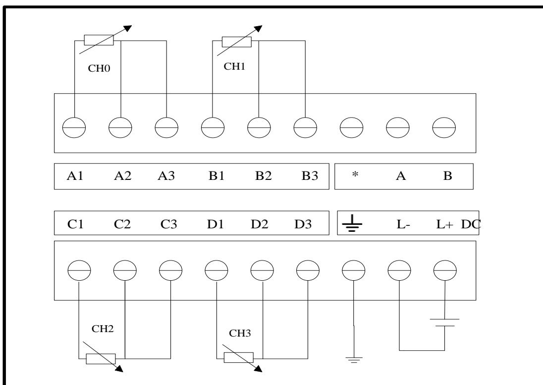
图 5-8 EC231-04RDM 三线制接线图
