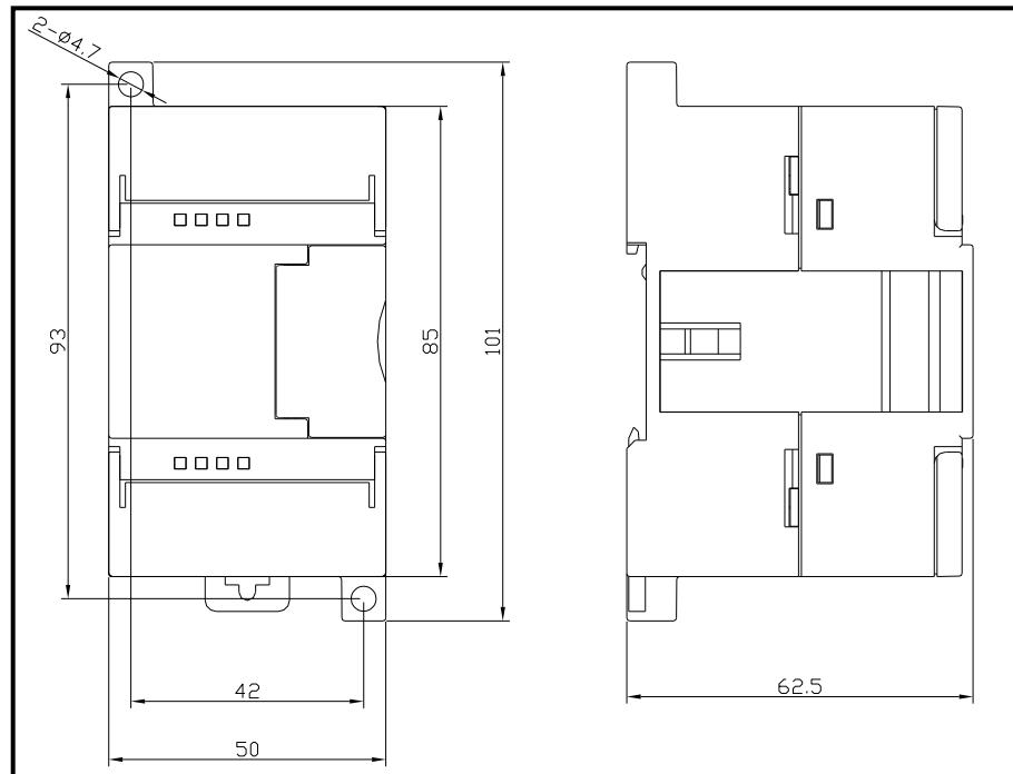
图 5-12 EC231-04TCM 安装尺寸图
