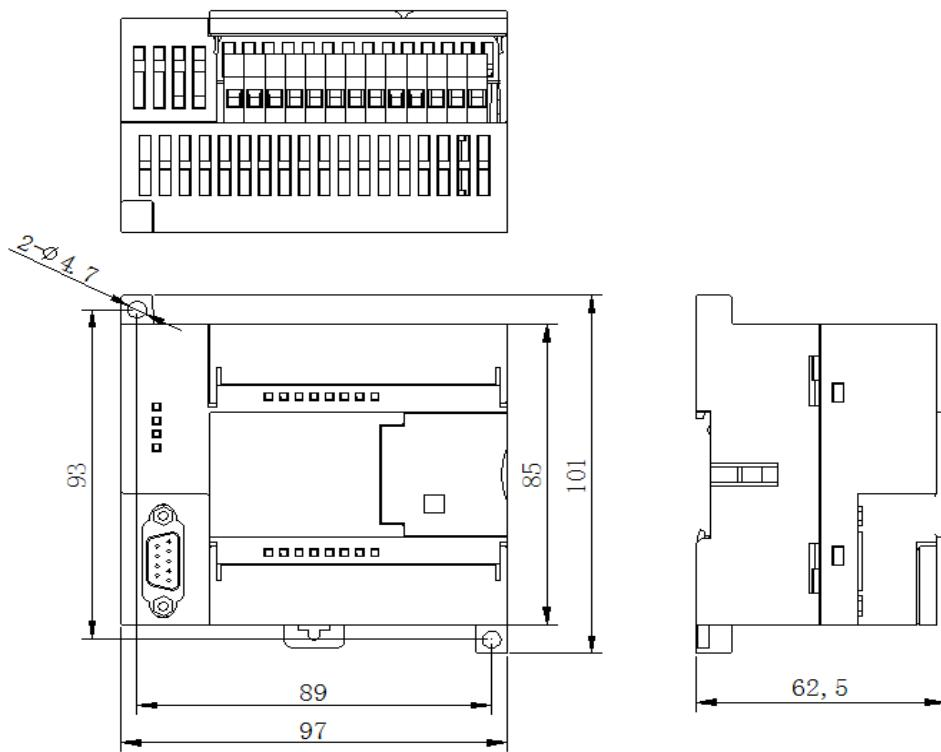
图 2-6 P3 外形尺寸及安装图
