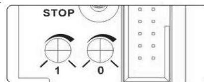
**注：**当两个顶调电位器同时处于最大处，且运行开关处于 STOP 时，重启 PLC，此时 PLC 处于待升级状态，RUN 灯以 10Hz 频率闪烁，此时可利用 Port0 进行写程操作。写程完毕后，RUN 常亮，恢复顶调电位器到最小处、恢复运行开关状态，系统重新上电，固件升级结束。
