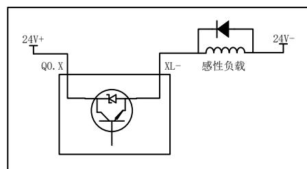
图 3-4 感性负载接线图
