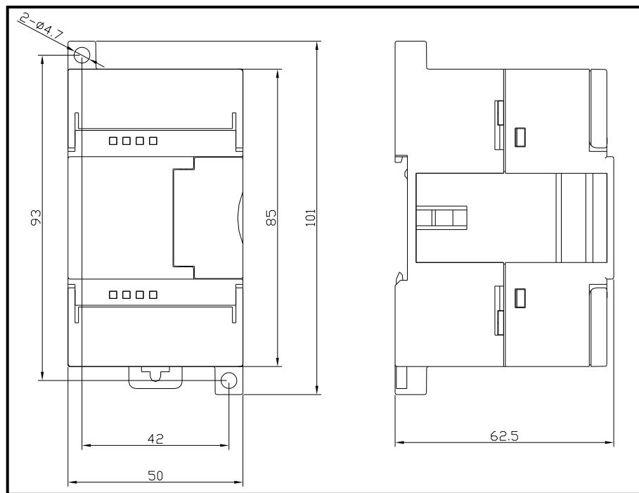
图 4-29 EC223-08DTD 安装尺寸图
