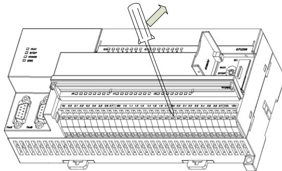
图 2-9 可插拔端子的拆卸示意图
