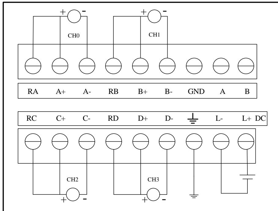
图 5-4 EC231-04IVM 接线图：电流信号（四线制）
