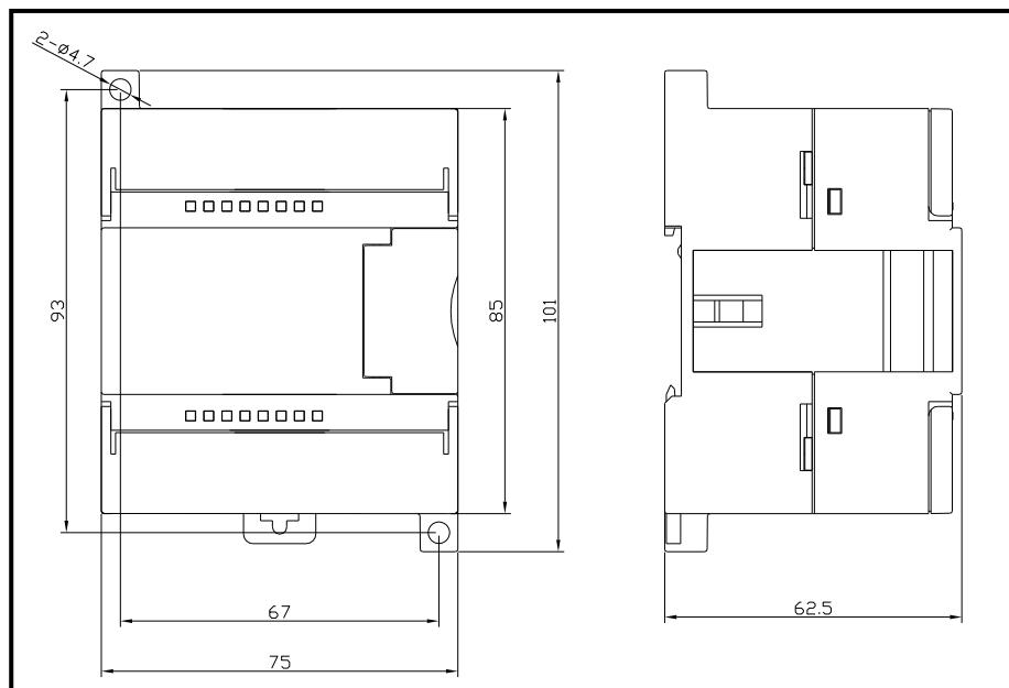
图 4-24 EC222-16XR 安装尺寸图
