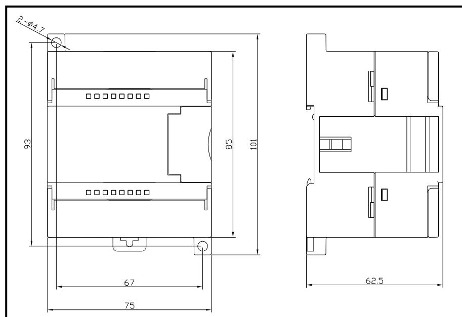
图 4-20 EC222-16DTD 安装尺寸图
