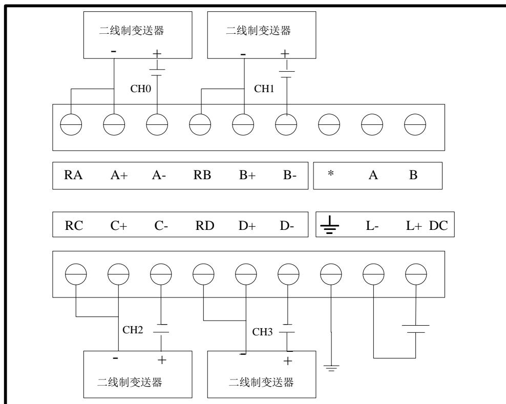
图 5-3 EC231-04IVM 接线图：电流信号（二线制）
