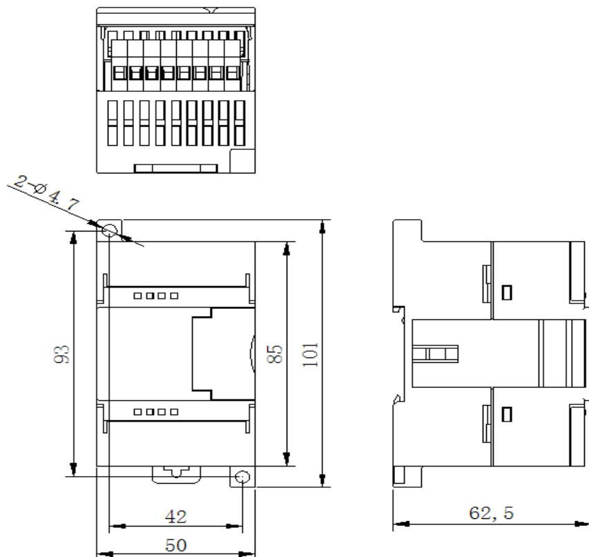
图 2-4 P1 外形尺寸及安装图
