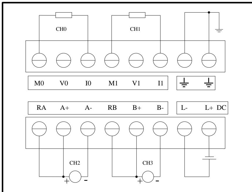
图 5-20 EC233-04IVM 电流四线制接线图
