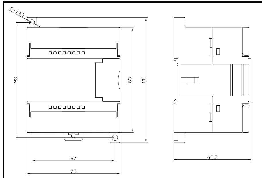
图 4-39 EC223-16DTD 安装尺寸图
