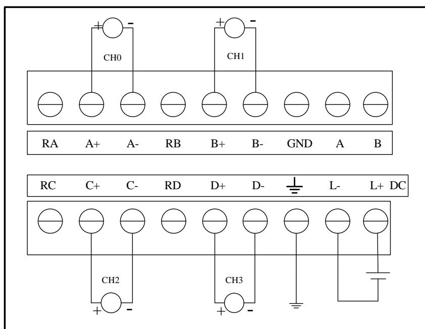
图 5-2 EC231-04IVM 接线图：电压信号
