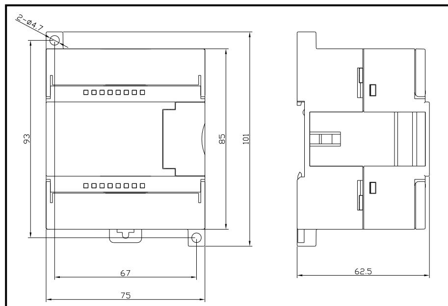
图 4-8 EC221-16DX 安装尺寸图
