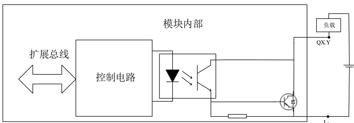
图 4-38 DO 漏型电气原理图
