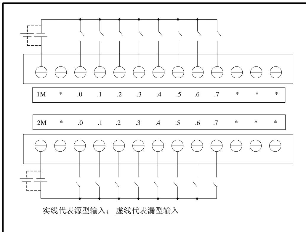
图 4-6 EC221-16DX 接线图
