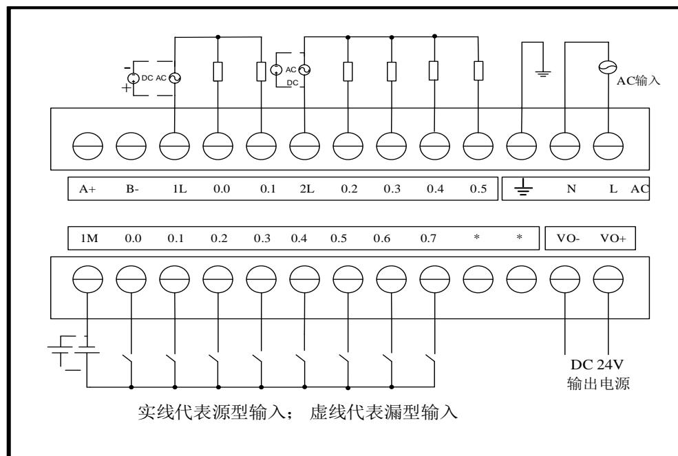
图 3-7 EC202-14AR 接线图
