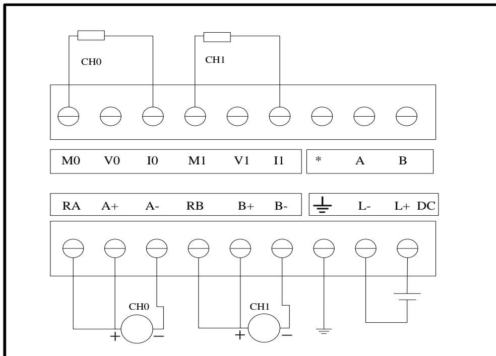
图 5-19 EC233-04IVM 电流模式接线图
