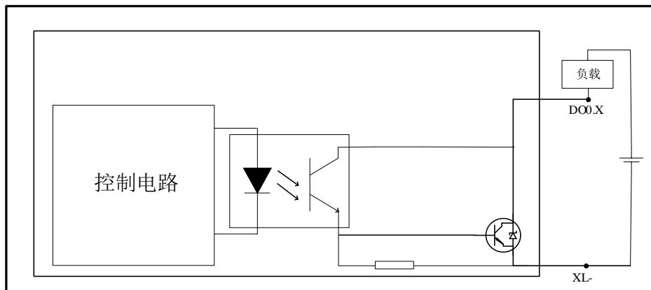
图 3-3 DO 输出通道电气原理图
