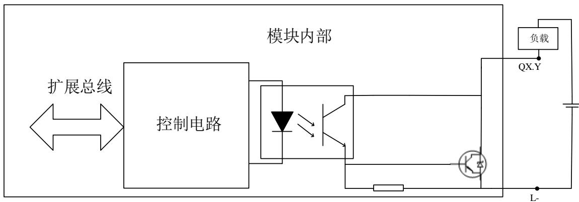
图 4-28 DO 漏型电气原理图
