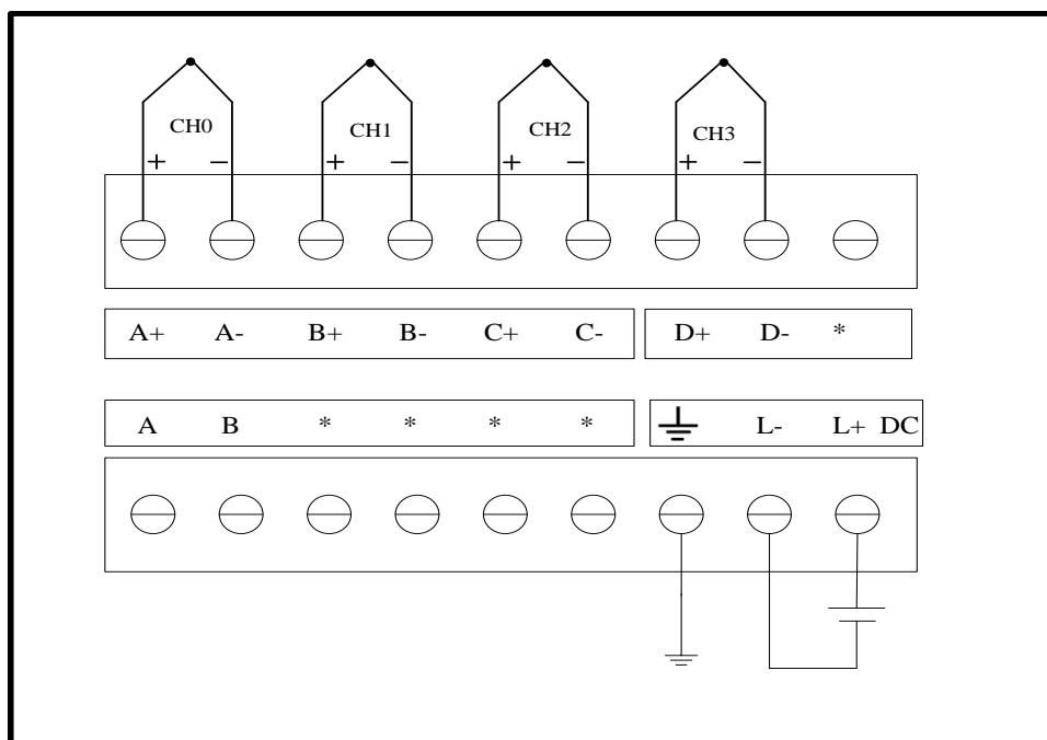
图 5-11 EC231-04TCM 端子接线图
