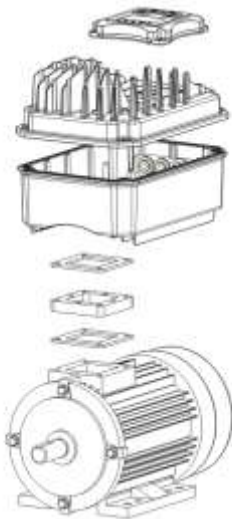
图 4-1-2 变频器与电机安装示意图
