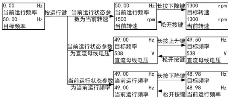
图 5-5 目标频率/目标转速调节流程图
