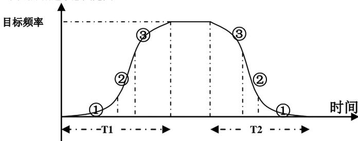
图 6-6 S 曲线加减速示意图
