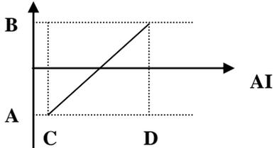
图 6-11 模拟给定与设定量的计算关系
