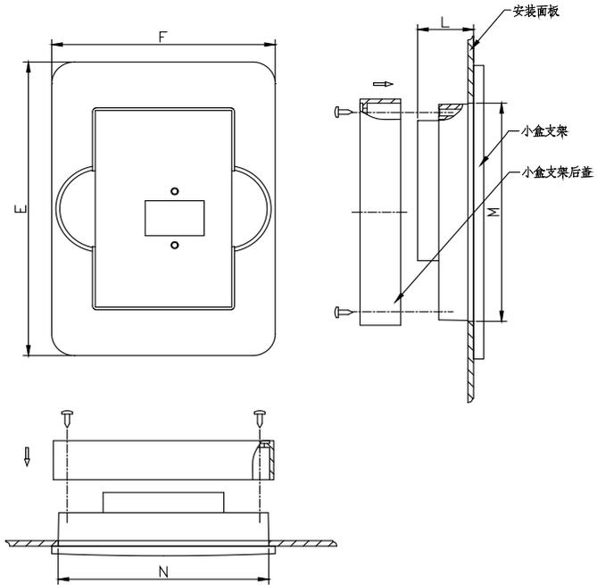
图 3-5 控制面板安装支架结构尺寸示意图
