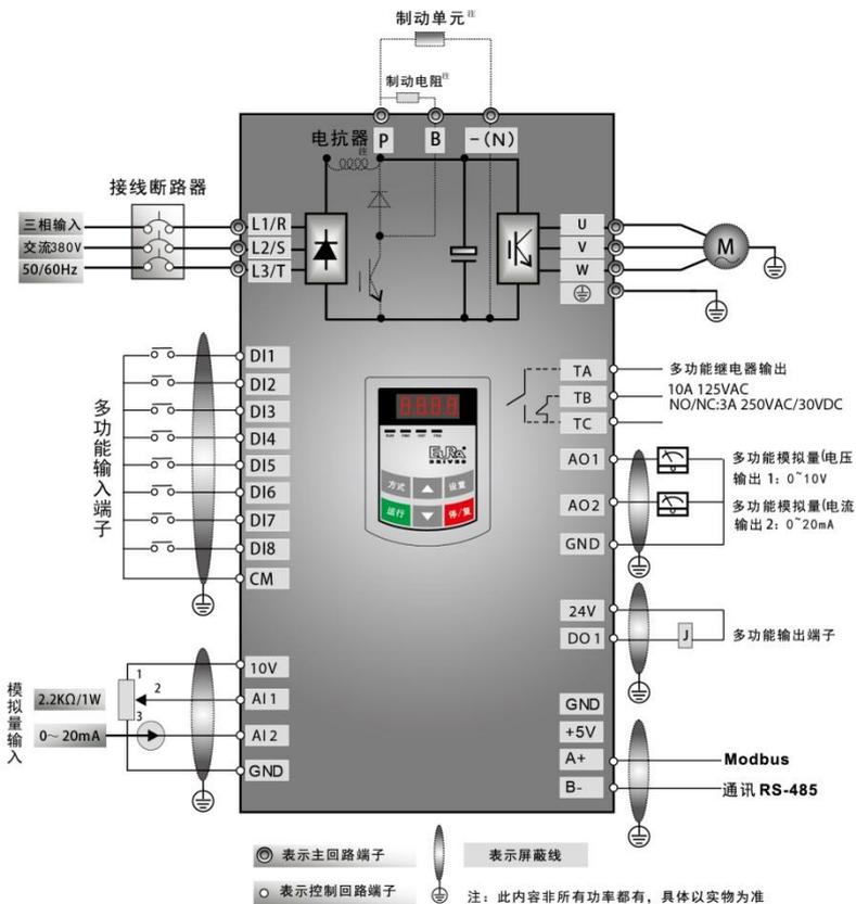
图 4-12 三相变频器标准配线图(NPN方式)
