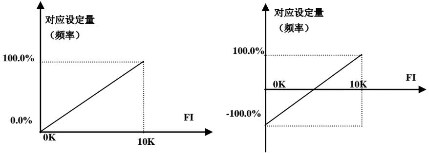
图 6-12 脉冲输入与设定量的对应关系
