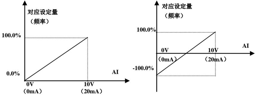
图 6-10 模拟给定与设定量的对应关系
