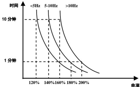
图 6-18 不同频率下的电机过载保护值
