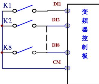
图 4-6 无源共源极接线方式示意图
