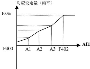
图 6-14 折线式模拟量输入与设定量关系
