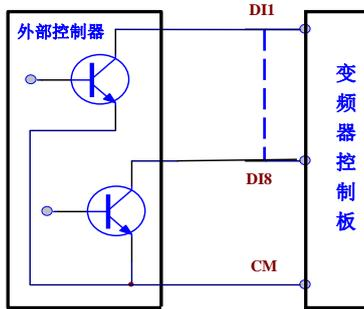
图 4-7 有源共源极接线方式示意图
