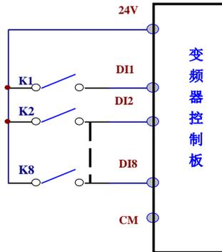
图 4-8 无源共漏极接线方式示意图
