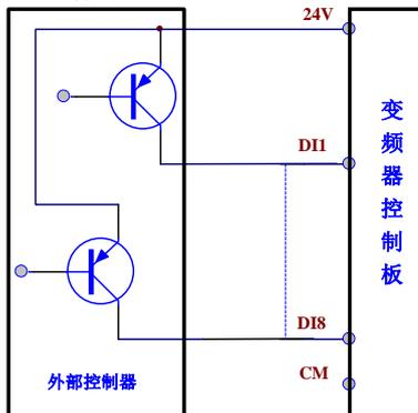
图 4-9 有源共漏极接线方式示意图
