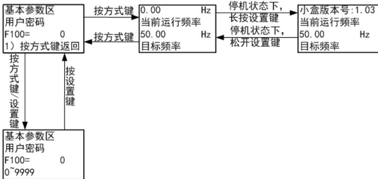
图 5-2 界面切换操作流程图
